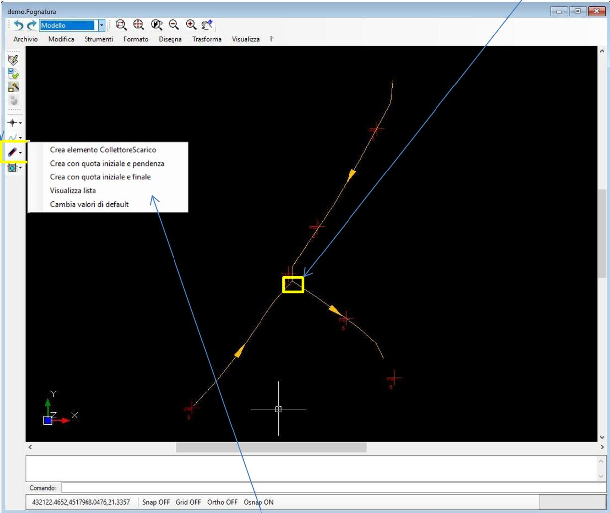
Crea elemento CollettoreScarico: con questo comando il collettore avrà un affondamento dell’estremo di valle fissato ed una pendenza verso monte pari a quella media del terreno
