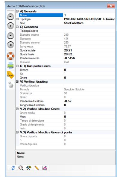
Finestra Info che appare se vi avvicinate ad un collettore sulla vista grafica. Attenzione: il contenuto è diverso a seconda se state in modalità **modello** o **verifica idraulica**.
