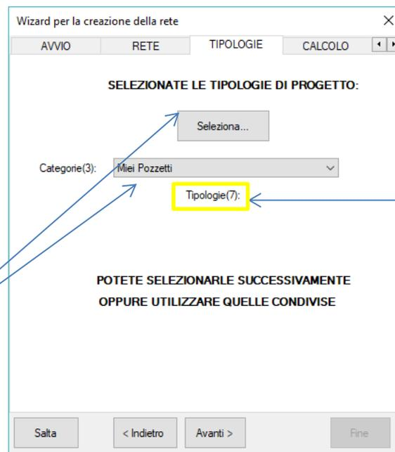
Ad esempio carichiamo la serie pvc 1401-S2 che contiene 7 tipologie di diametri con scabrezze inserite per tutti i tipi di formula. Una volta caricate le tipologie vedremo il contatore aumentare di 7. Ne posso caricare quante ne voglio, anche successivamente.
