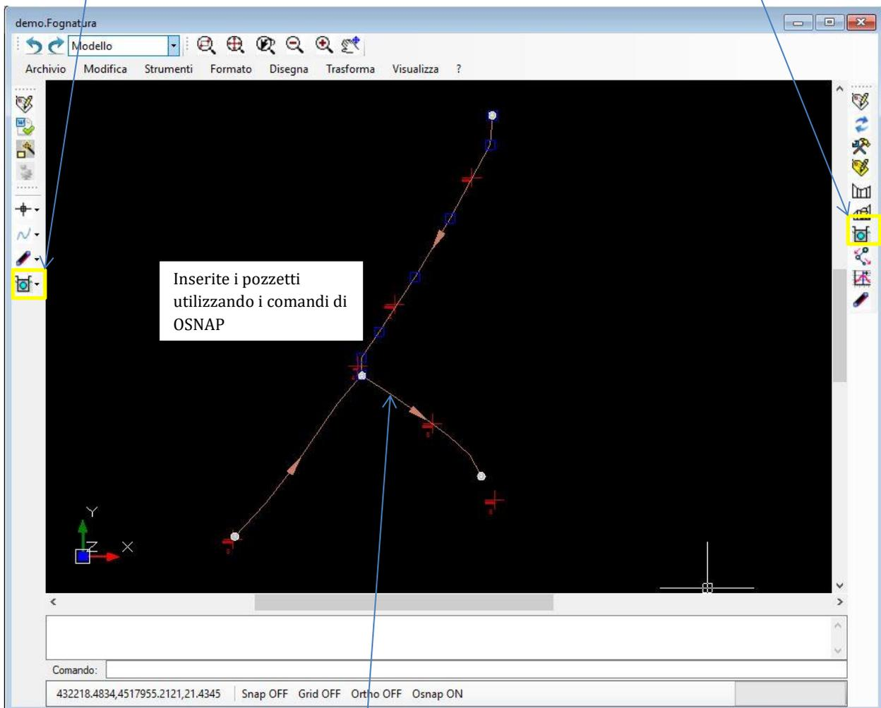
Potete inserire **pozzetti esterni o di confluenza** ubicandoli sulla rete in una data posizione planimetrica oppure **pozzetti interni** ad un collettore in un particolare **vertice** o ad una specifica **progressiva**. I primi non appartengono ad uno specifico collettore e se li spostate si *trascinano* tutti i collettori ad essi agganciati. Quelli interni invece si muovono assieme al collettore (sono solidali con esso) e se il collettore viene eliminato automaticamente sono *cancellati*.
