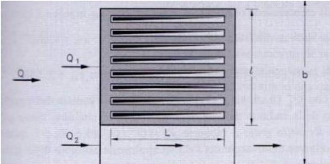
Innanzitutto definire le caratteristiche della corrente in arrivo alla cunetta. La portata, espressa in l/s è quella che si vuole intercettare, ma il valore della velocità e del tirante idrico sono essenziali per calcolare la lunghezza longitudinale  $L$  necessaria per intercettare l'intera portata.
